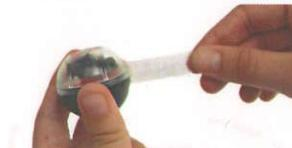
2. Чтобы освободить защелку, с помощью плоскогубцев слегка надавите на экватор зонда.
