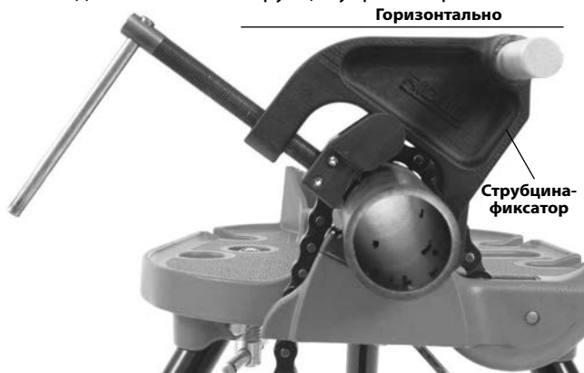
Рис. 11А – Расположение струбцины-фиксатора
