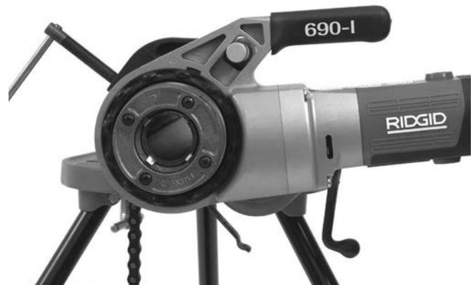
Рис. 12 – Правильное расположение силового привода
