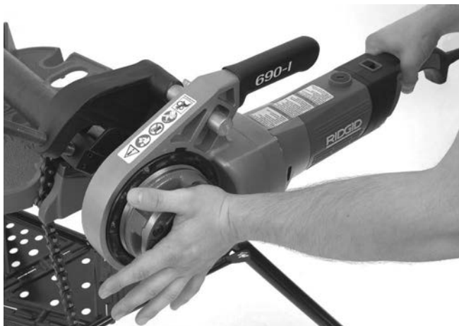
Рис. 13 – Начало нарезания резьбы
