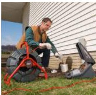
Для труб 40 - 200 мм (\* 50 - 300 мм) длиной до 61 м. Проходит отводы 90° диаметром от 50 мм (\* от 75 мм).
