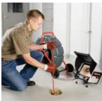
Для труб 50 - 300 мм длиной до 99 м. Проходит отводы 90° диаметром от 75 мм.
