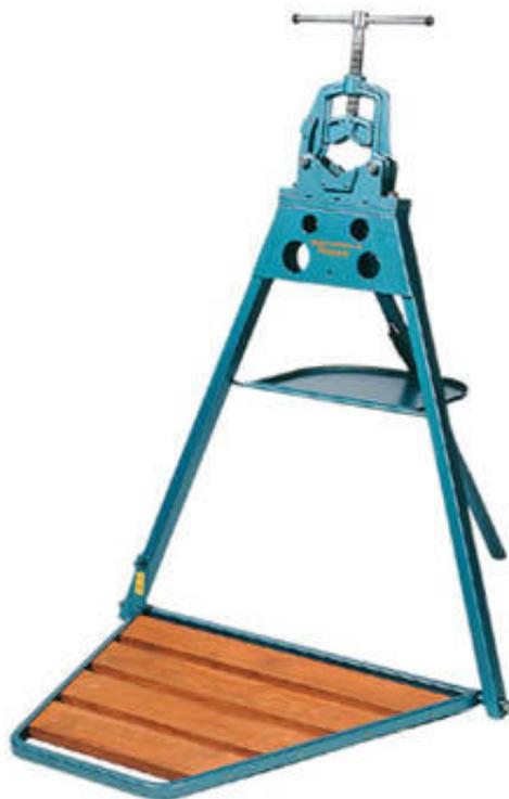
Портативный рабочий штатив Pioneer с трубными тисками. Оснащен откидными трубными тисками, плитой для гибки труб, полкой для хранения инструмента и откидным напольным дощатым настилом для устойчивости. Модель № 2 гнет трубы от 1/2" до 1 1/2". Модель № 3 гнет трубы от 1" до 2". Обе модели могут быть оснащены тисками [Matador](#) или [Superior](#) модели 120 (для тисков требуется специальный фиксатор).
